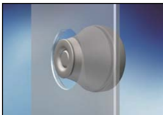
Drücken Sie die Tülle durch die Öffnung.
