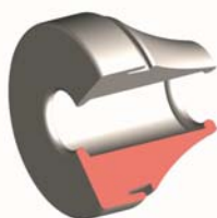
Drücken Sie die Tülle durch die Öffnung.
