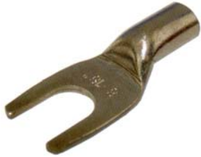
Rohrkabelschuhe Gabelform 0,5-16mm 2 Cu.verzinkt nach DIN EN 13600
