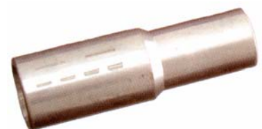
Pressanschlußbolzen 120-240mm 2 Hülßenmaße nach DIN 46235 Cu.verzinkt nach DIN EN 13600
