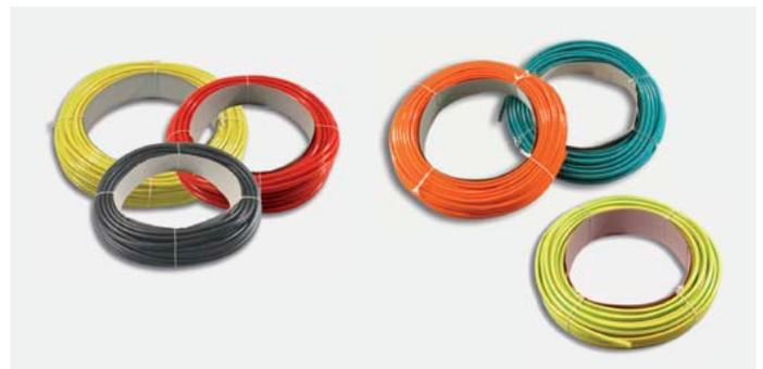
Der PVC-Isolierschlauch hat den Vorteil, dass er in verschiedenen Farben lieferbar ist. Er ist licht-, ozon-, alterungs- und säurebeständige und eignet sich speziell für die Isolation, als mechanischen Schutz, zum Bündeln und Verlegen von elektrischen Kabeln.
