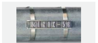
Markierer bis 540°C aus nichtrostendem Stahl. Befestigung mit Edelstahl-Kabelbinder.
