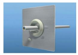
02. führen Sie das Kabel durch die Tülle
