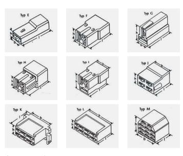
① Die Gehäuse für Flachstecker passen zu den entsprechenden oben abgebildeten Gehäusen für Flachsteckhülsen.
