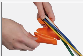
01. Kabel in das Montagewerkzeug legen
