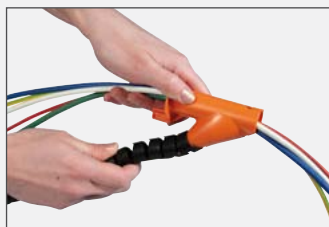
03. Montagewerkzeug in den Spiralschlauch einführen
